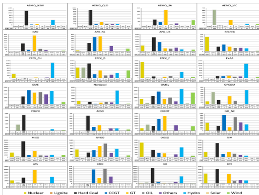
FIGURE – Distribution des capacités installées dans différents marchés dans le monde (Platts WEPP, 2009)
